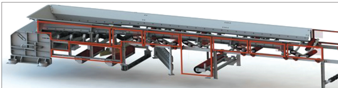
Rys. 3. Przykład rozmieszczenia osłon miejsc niebezpiecznych (pozycje czerwone)
