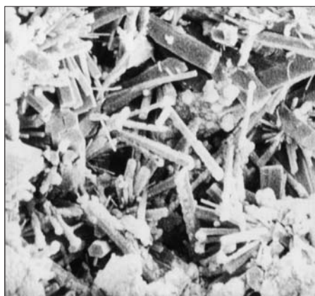
Рис. 3. Идеоморфность очертаний и беспорядочная ориентировка в пространстве кристаллов гидросиликатов кальция. Увеличение 3000×
