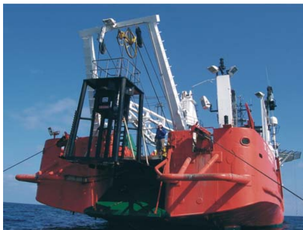
Rys. 3. Opuszczanie konstrukcji Roson 10 Tf na dno
