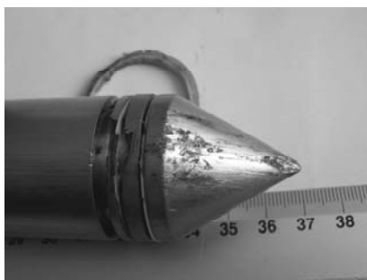
Rys. 6. Uszkodzona końcówka pomiarowa CPTU
